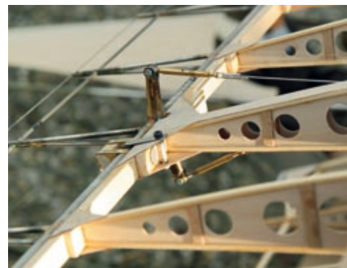
Das Querruder-Ruderhorn in Funktion
