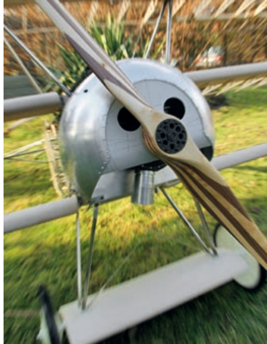
Mit viel Aufwand wurde die Aluminium-Motorhaube auf einer speziellen Drückbank hergestellt
