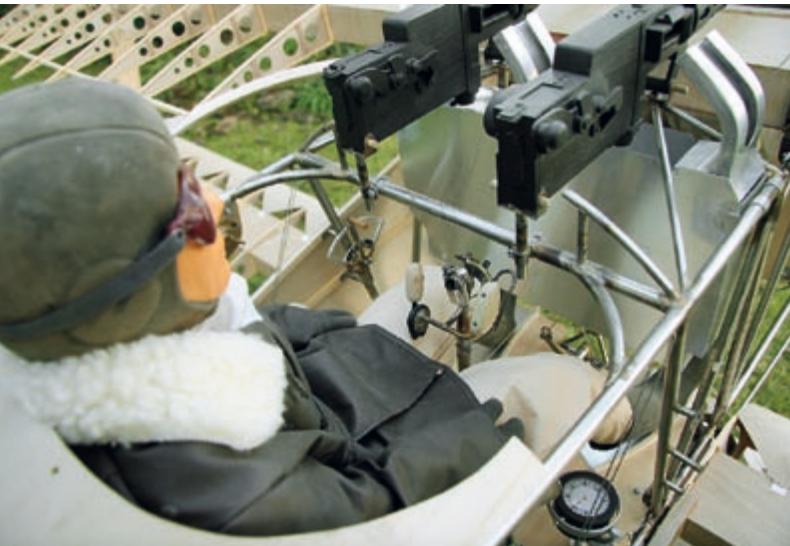
Der „Arbeitsplatz“ des Piloten lässt die aufwändigen Rohrarbeiten erkennen
