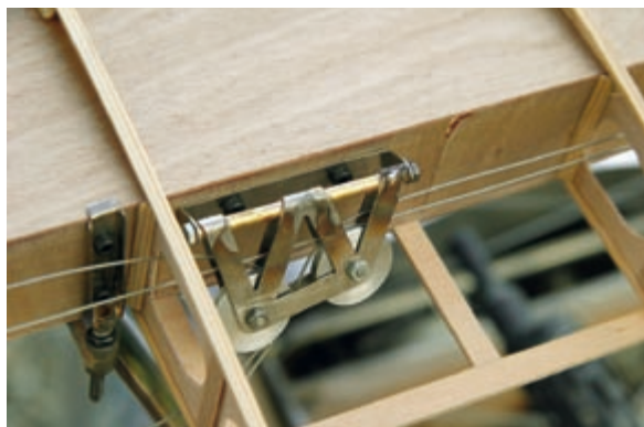
Aufwändiges, voll funktionstüchtiges Umlenksystem für die Querruderanlenkung
